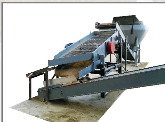
Комплекс подготовки и дозирования сырья, поставленный и запущенный нашими специалистами в г. Череповец
