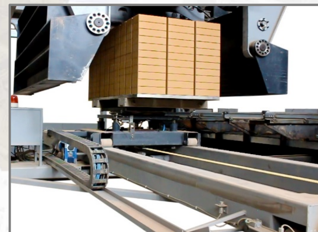
Манипулятор-пакетировщик разработанный и поставленный нашими специалистами на кирпичный завод производительностью 15 млн. усл. кирпичей в год
